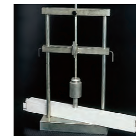
Attrezzatura per prova asportazione lamella e segmento fianco.
