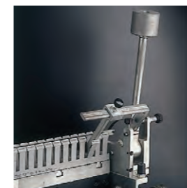
Attrezzatura per prova asportazione lamella e segmento fianco.
