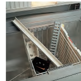
Cella frigorifera per condizionamento provini alla prova urti a bassa temperatura.
