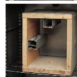
Attrezzatura per prova abbassamento coperchi e pareti laterali.
