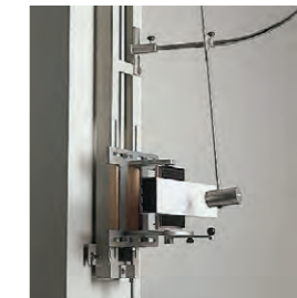
Cella frigorifera per condizionamento provini alla prova urti a bassa temperatura.
