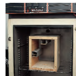
Camera climatica per prova di invecchiamento accelerato.
